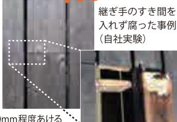
継ぎ手のすき間を入れず腐った事例(自社実験)
